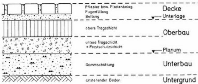
Der Unterbau unter der Pflasterung besteht aus:
